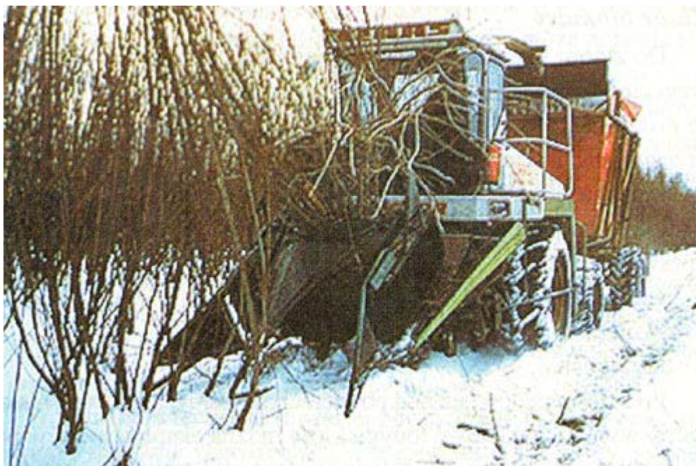
Fot. 5. Kombajn Claas Jaguar używany do zbioru roślin wierzb krzewiastych w Szwecji
