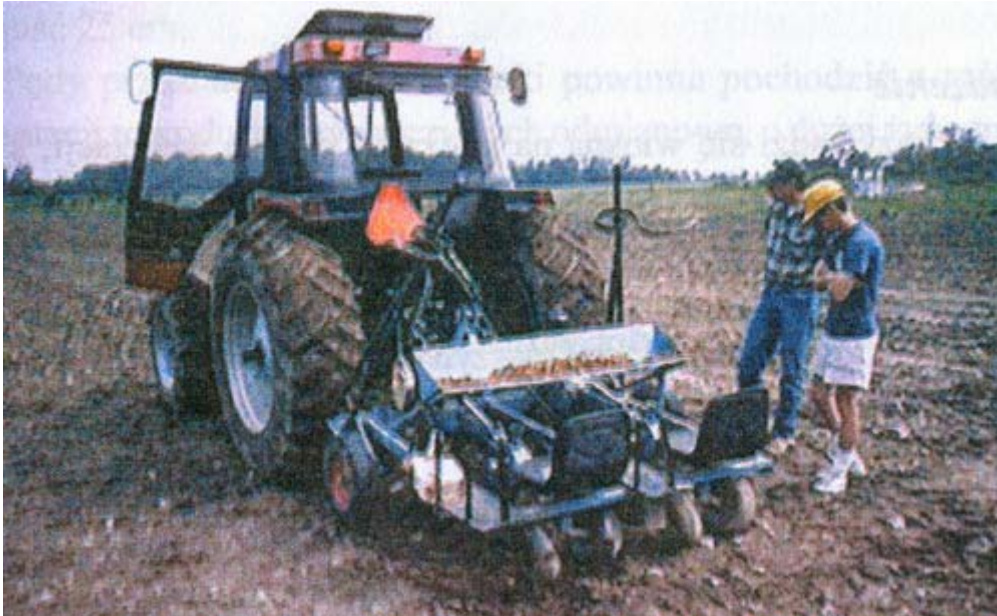
Fot. 1. Dwurzędowa sadzarka do sadzenia zrzeczów wierzb krzewiastych.
